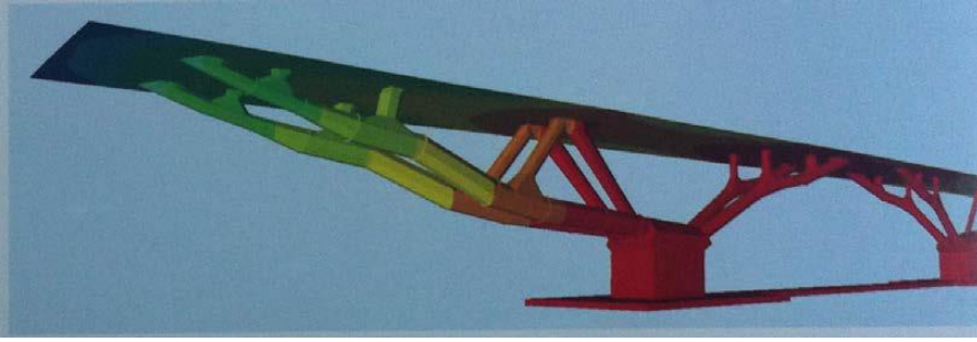
Şekil 3.25 : Strüktürel kesitlerin belirlenmesi (Burry 2012).
