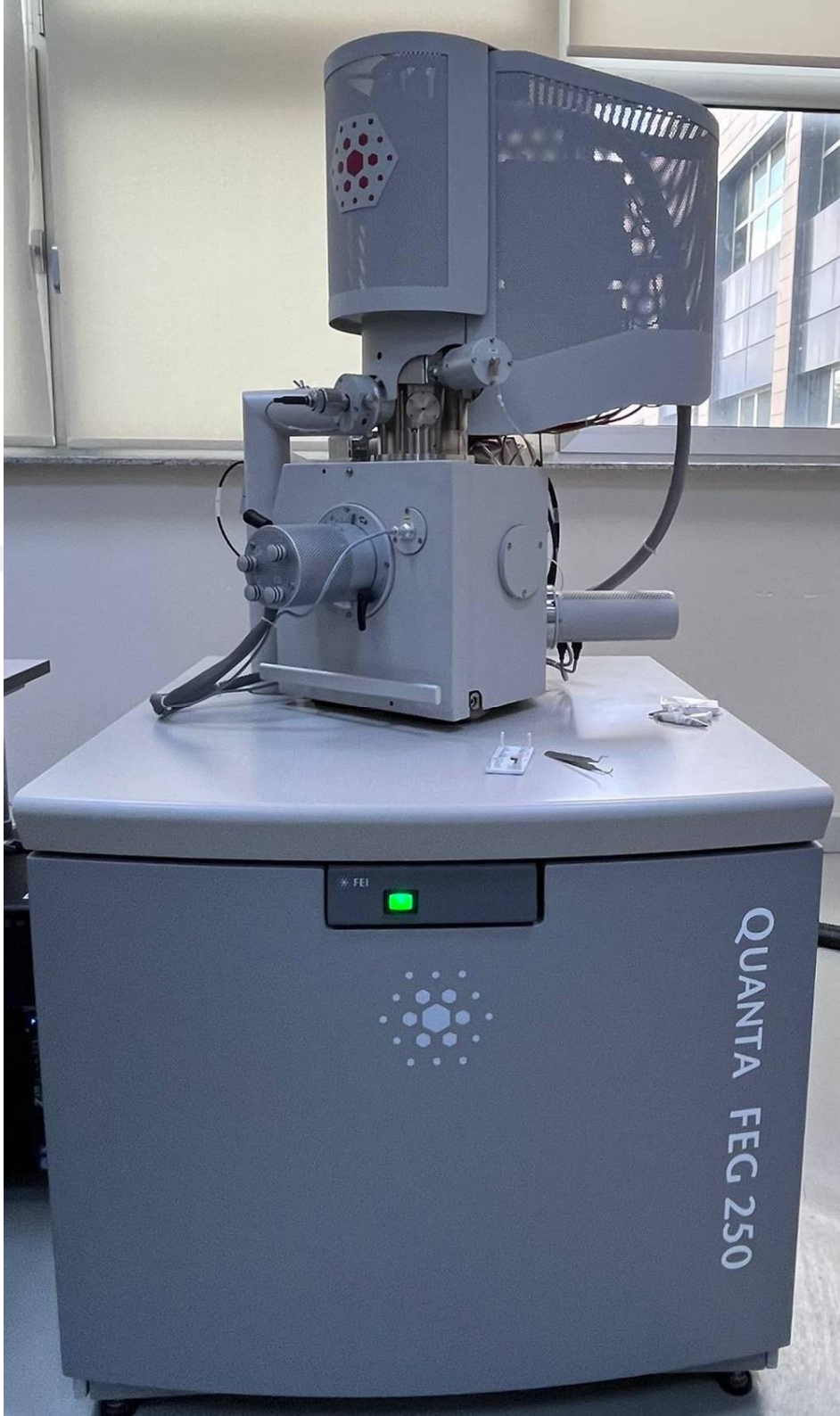
Şekil 3.7 Quanta FEG 250 SEM cihazı
