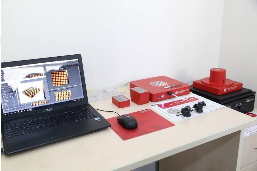
Şekil 3.8 EzAFM-Compact AFM cihazı
