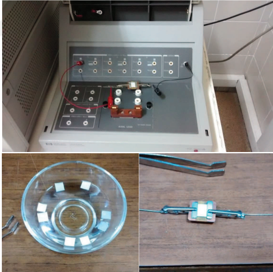
Şekil 3.8. (a) İletkenlik ölçümü için kullanılan cihazın örnek yerleştirme modülü, (b) örneklerin ölçüm öncesi fosfat tampon çözeltisinde bekletilmesi, (c) ölçüm için hazırlanan malzeme.
