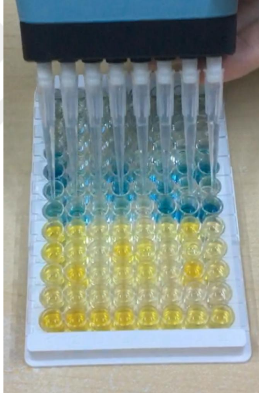
Şekil 3.6. Stop Solüsyonunun Eklenmesi ile Rengin Maviden Sarıya Dönmesi
