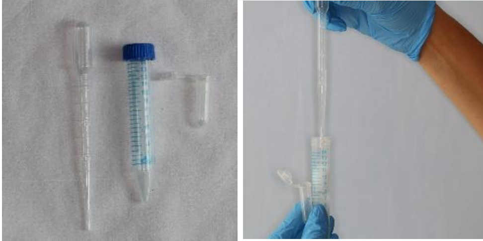
Şekil 3.3. Tükürük örneklerinin alınması için kullanılan falkon tüp, eppendorf ve pastör pipet
