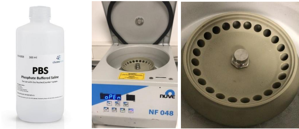
Şekil 3.6. DOS örneklerinin elüe edildiği PBS ve santrifüj edildiği eppendorf santrifüj cihazı
