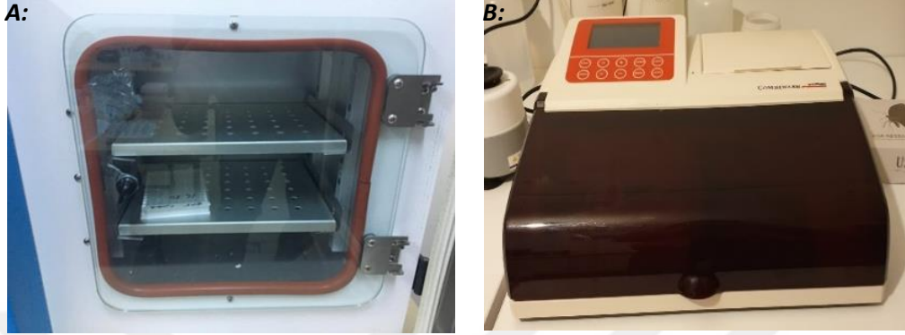
Şekil 3.7. A:ELİSA mikrokuyucuklarının inkübasyona bırakıldığı fırın ve B.Otomatik yıkama cihazı
