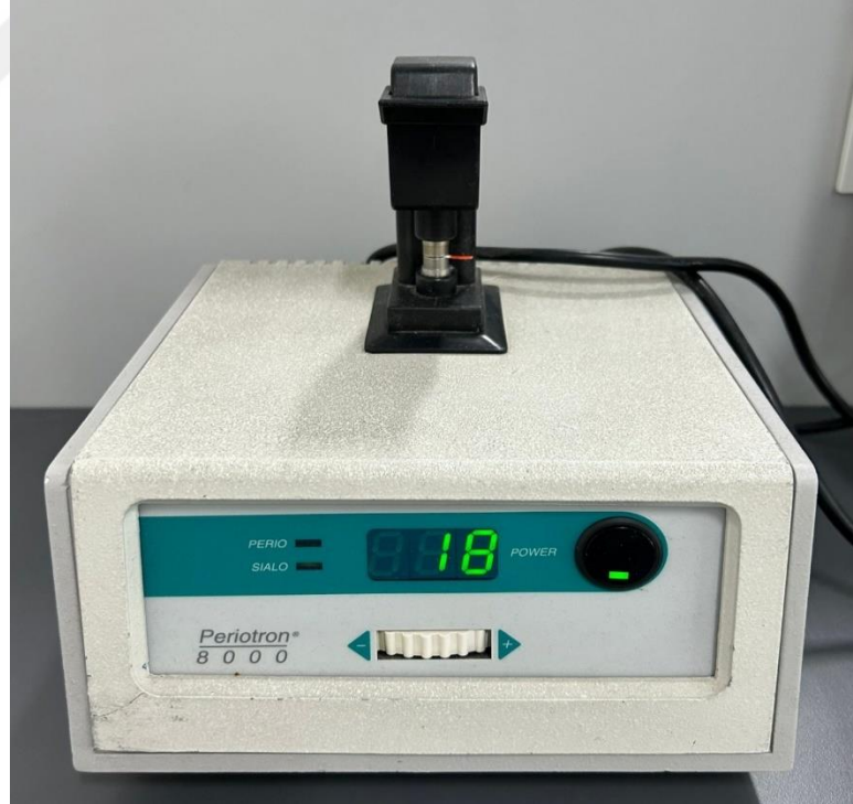
Şekil 3.3. Kağıt şeritlerle toplanan DOS'un hacimsel analizi için kliniğimizde kullandığımız periotron cihazı
