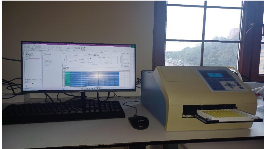
Şekil 3.12. Thermo Scientific, Multiskan GO cihazında mikrolukanın okunması, standart grafiklerin çizimi ve sonuçların hesaplanması
