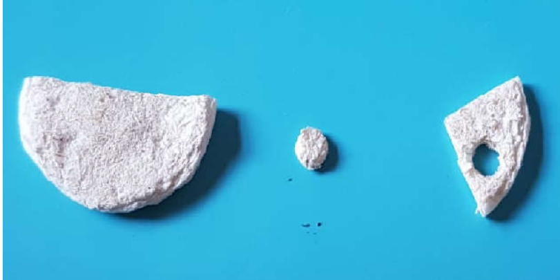
Şekil-11: Üretilen doku iskelesi ve hücre ekimine uygun boyutlara getirilmiş hali
