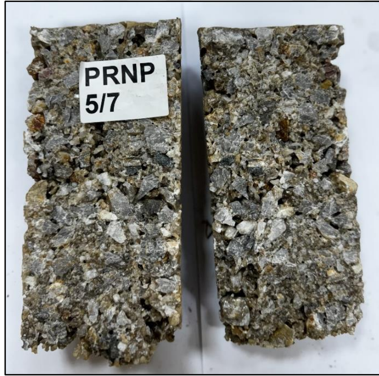
Şekil 22. PRNP5/7' nin kırılma modu
