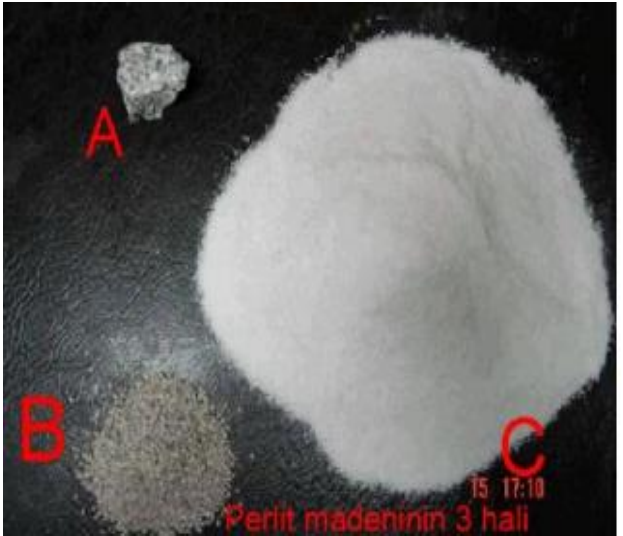
Şekil 8. Kayaç haldeki perlit (A), ham perlit (B) ve genişleştirilmiş perlitin (C) görünümü (Azizi, 2007)
