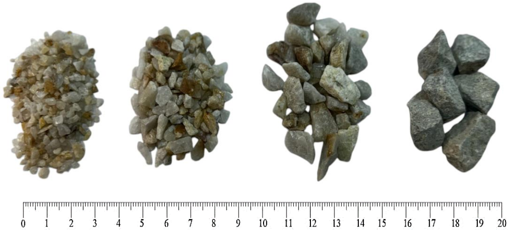
řekil 10. Elek analizi sonrası kuvars agregaları ve akılın grntleri
