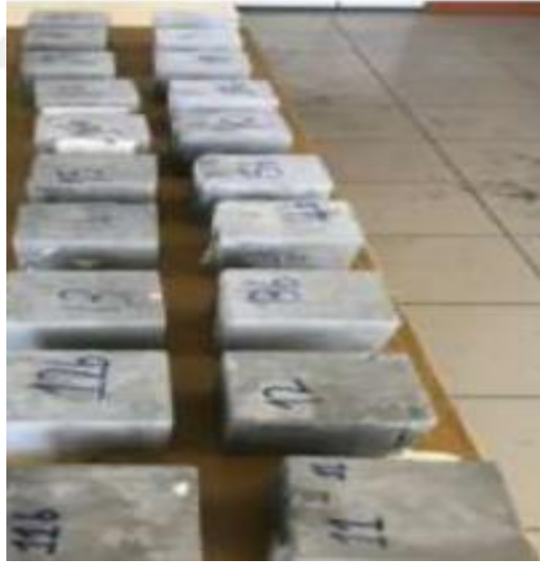
Şekil 3.4. Kalıplardan çıkarılmış numune betonlar
