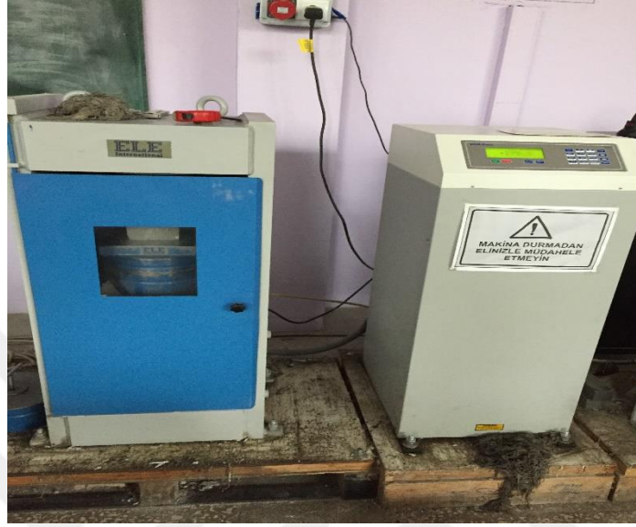
Şekil 3.5. Basınç ve çekme dayanımı deney düzeneği
