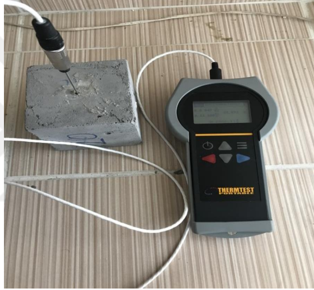
Şekil 3.6. Isı iletim katsayısı ölçümü alınan beton numune
