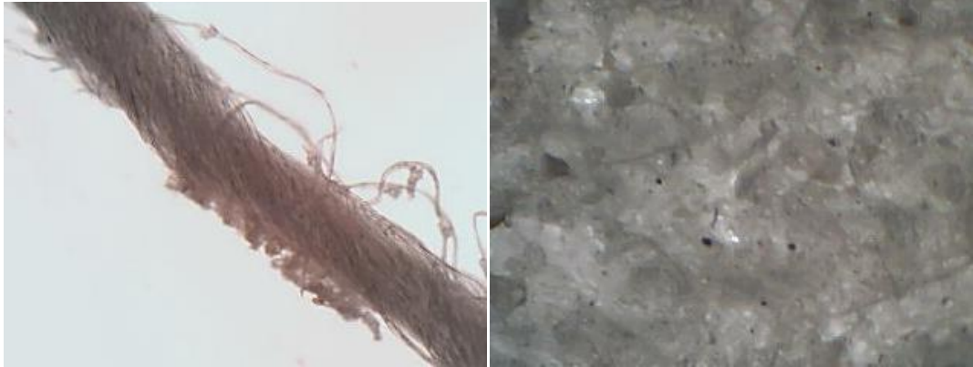
Şekil 3.4 Ham perlit ile tek taraflı kaplanmış kumaştaki mikroskop altında iplik (sol) ve kumaş yüzeyi (sağ) görüntüleri
