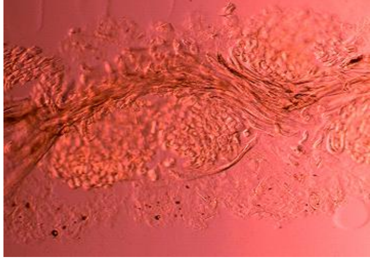
Şekil 3.17 Genleştirilmiş perlit ile çift taraflı kaplanmış kumaş kesiti görüntüsü
