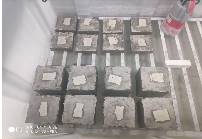
Şekil 3.11. Hafif beton numunelerinin kürlenmesi
