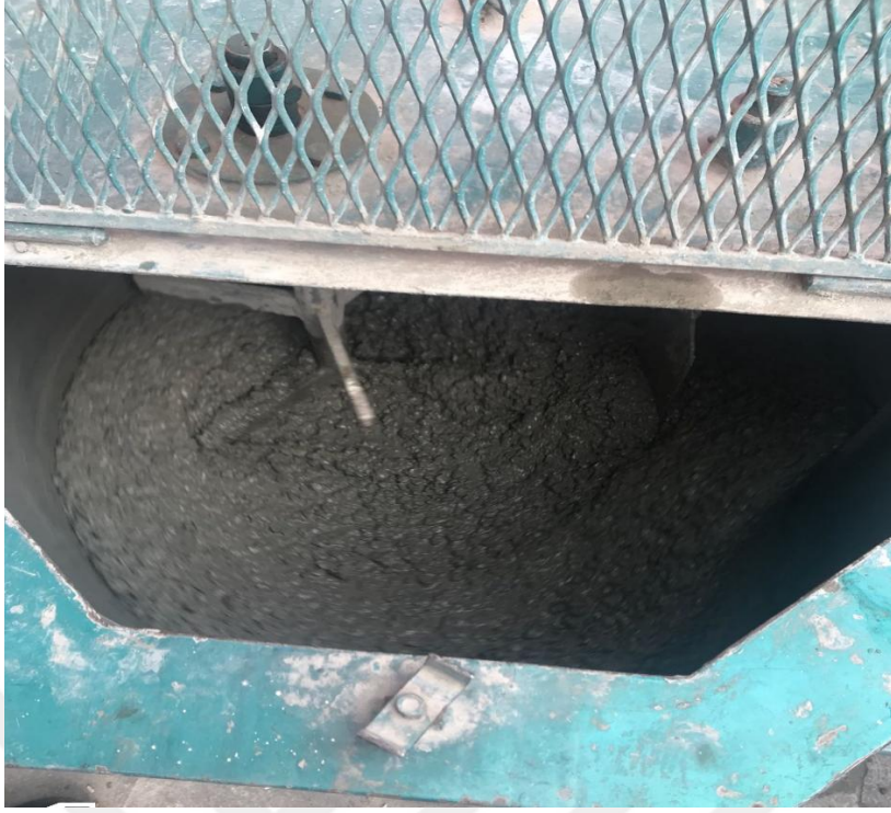
Şekil 3.6. Hafif beton numunelerinin hazırlanması
