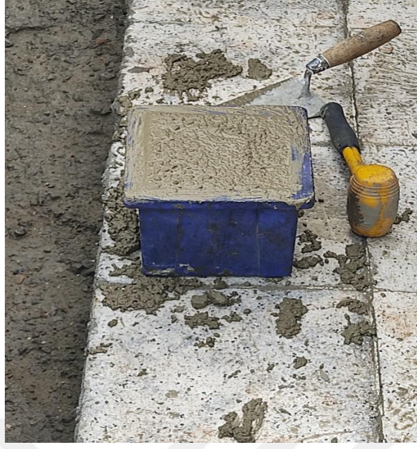
Şekil 3.9. Hafif betonun kalıplanması
