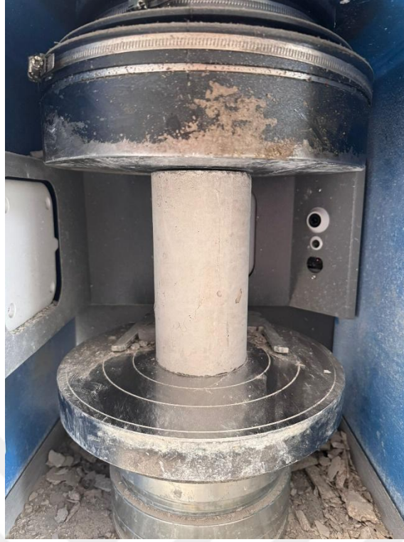
Şekil 3.14. Silindir numunenin basınç dayanımı deneyi
