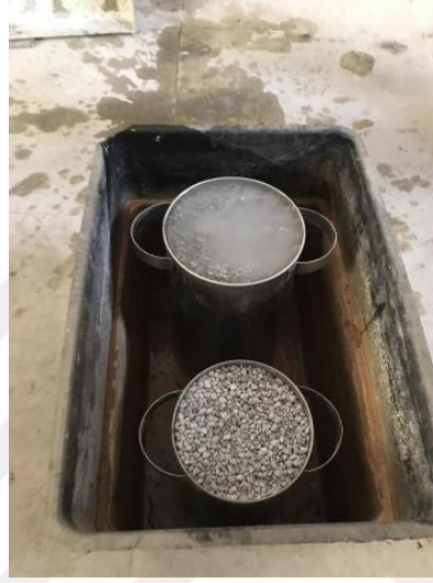
Şekil 4.5. Suda bekletilen perlit agregası
