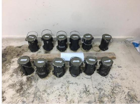
Şekil 4.11. Beton dökümü sonrası 7 ve 28 gün için alınmış olan silindir numuneler
