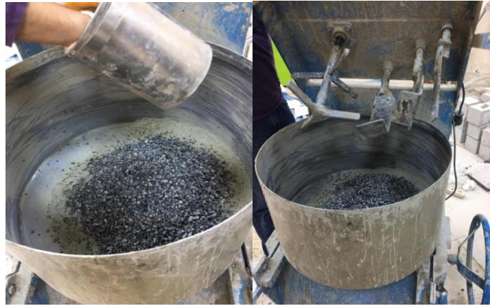
Şekil 4.9. Ön deney numune beton döküm çalışmaları
