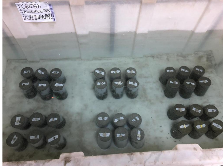
Şekil 4.12. Ön deney çalışmaları için dökülmüş olan beton silindir numuneleri
