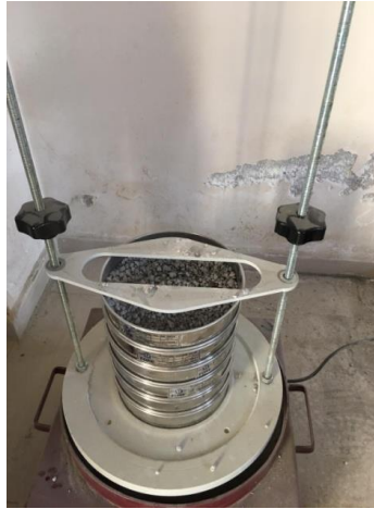
Şekil 4.4. Perlit agregası eleme düzeneği
