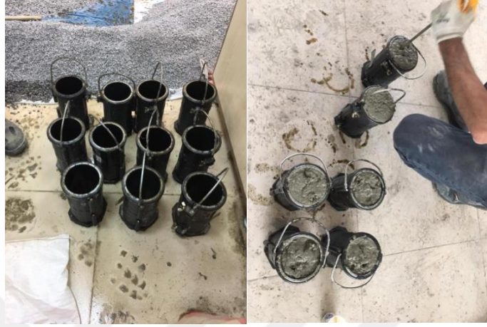
Şekil 4.10. Deney numunelerinin uygun şekilde sıkıştırma işleminin yapılması
