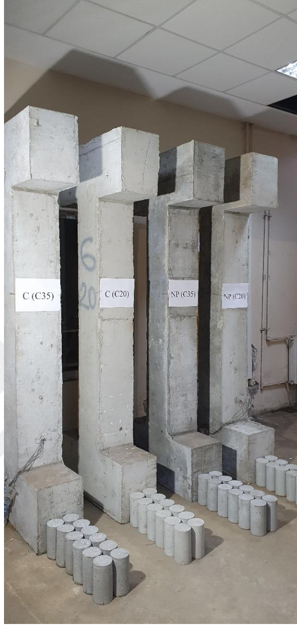
Şekil 4.19. 28 gün sonrasında deneye hazır olan betonarme kolon numuneler
