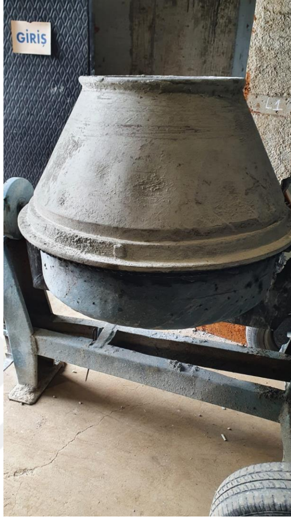
Şekil 4.16. Beton dökümü gerçekleştirilen betoniyer
