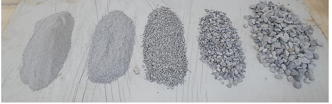
Şekil 4.8. Ayrı tane boyutlarına ayrılmış perlit agregası
