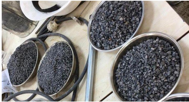
Şekil 4.7. Islatılmış şekilde kuruması beklenen perlit agregası
