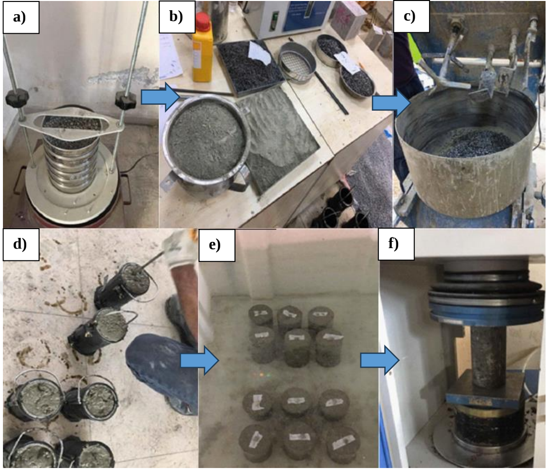
Şekil 4.2. Ön deney çalışmalarına ait görseller (a) Doğal perlit agregasının elenmesi (b) Elenmiş perlit agregaları (c) Mikser yardımıyla betonun hazırlanması (d) Kalıba yerleştirilen betonlar (e) Dökülen betonların kürlenmesi (f) Beton basınç dayanımı testi.
