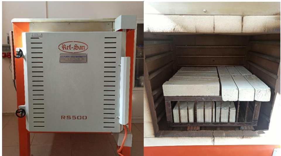
Şekil 4.5. Yüksek sıcaklık için kullanılan büyük deney fırını.
