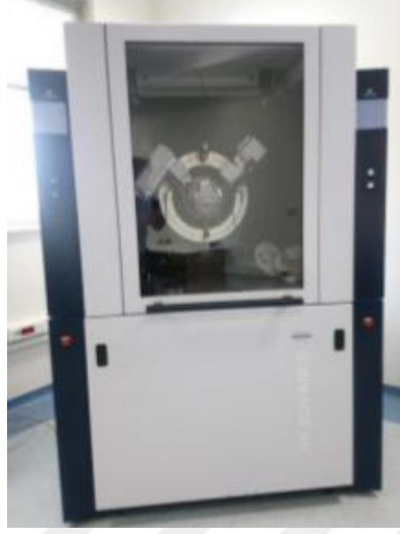
Şekil 3.9. X-Işını Toz Difraktometresi cihazı
