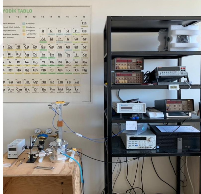
Şekil 3.16. Tabakalarının optiksel karakterizasyonu için kullanılan fotoiletkenlik ölçüm sistemi
