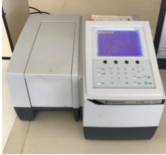
Şekil 3.11. UV analizi Shimadzu 2600 cihazı
