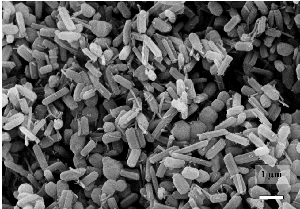
Şekil 9.24. SBA-15 katalizörün SEM görüntüsü.
