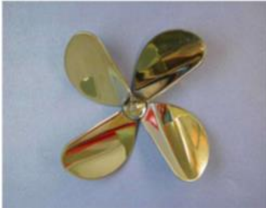
Şekil 3.6. Deneylede kullanılan pervane örneği (Maritime Models, 2013)
