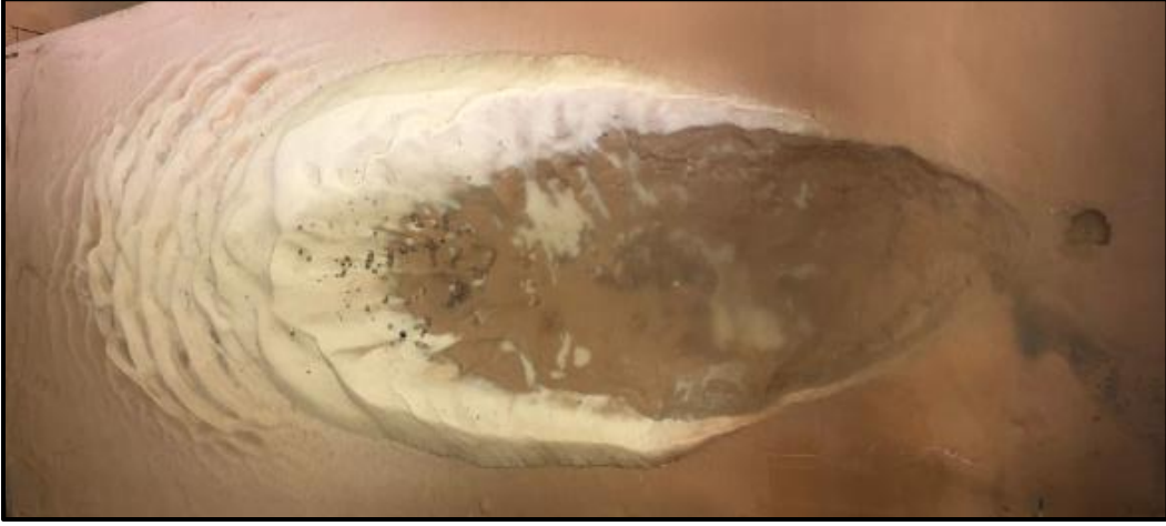
b) 1000 rpm G=0.06m %5 kil karışım tabanda oyulma alanı
