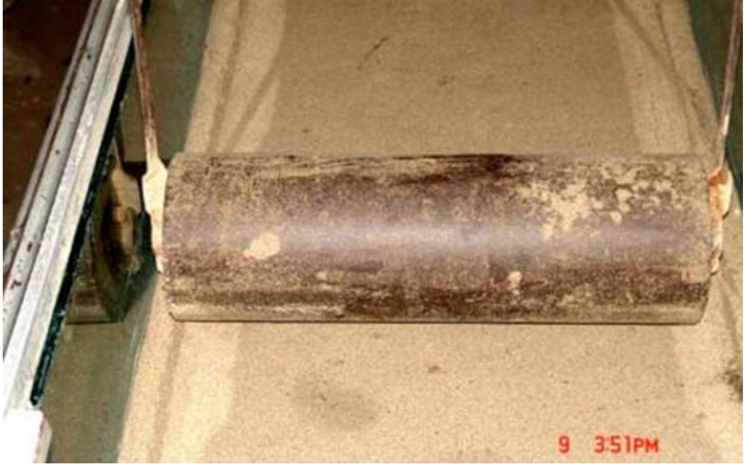
Şekil 2.12. Yatak malzemesini sıkıştırmak için kullanılan kanal genişliğine uyacak şekilde özel olarak üretilmiş silindir (Kothyari ve Jain, 2008)
