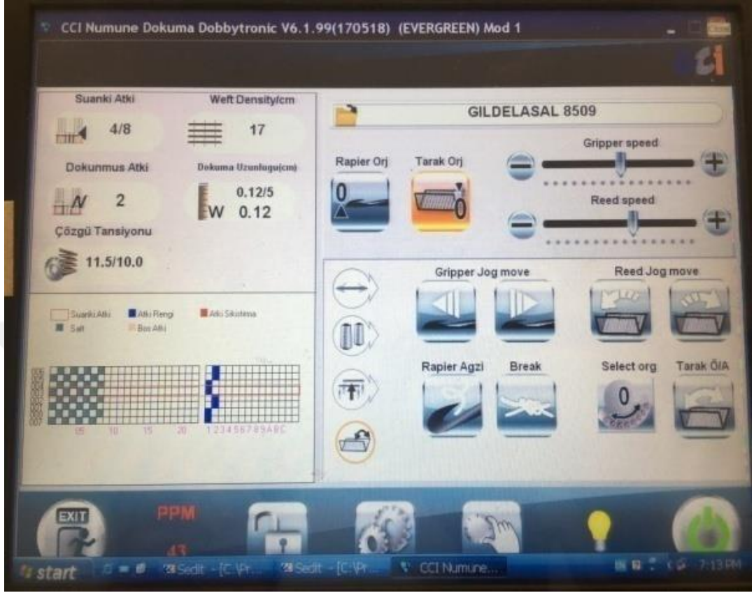
Şekli 1.11. Otomatik numune şablon makinesi monitörü
