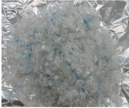
Resim 5.1. Atık PET çapak örneği [39]
