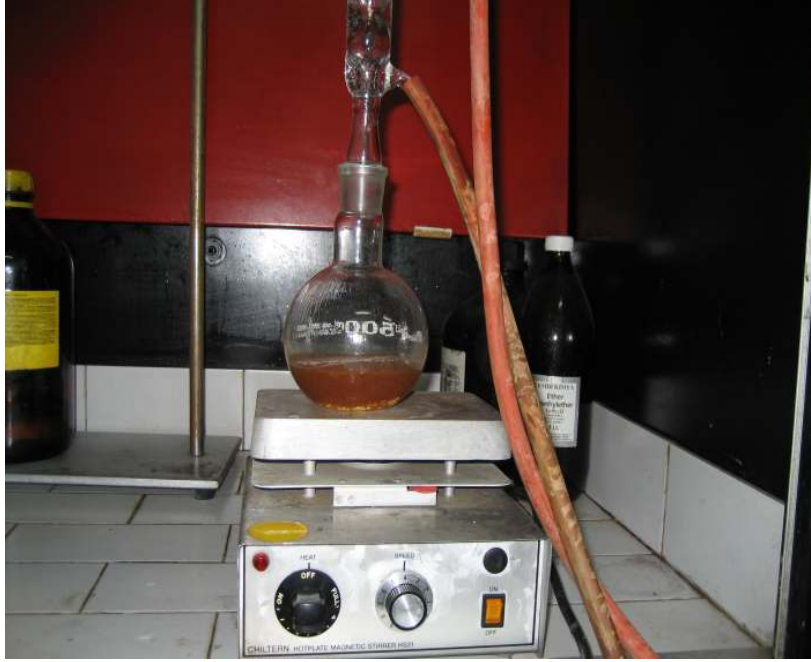
Resim 6.1. Geri soğutucu altında gerçekleştirilen tepkime [39]
