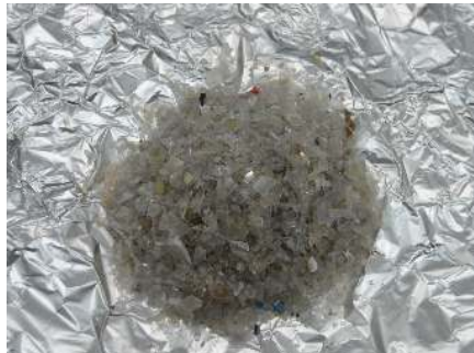
Resim 5.2. Atık PVC çapak örneği [39]
