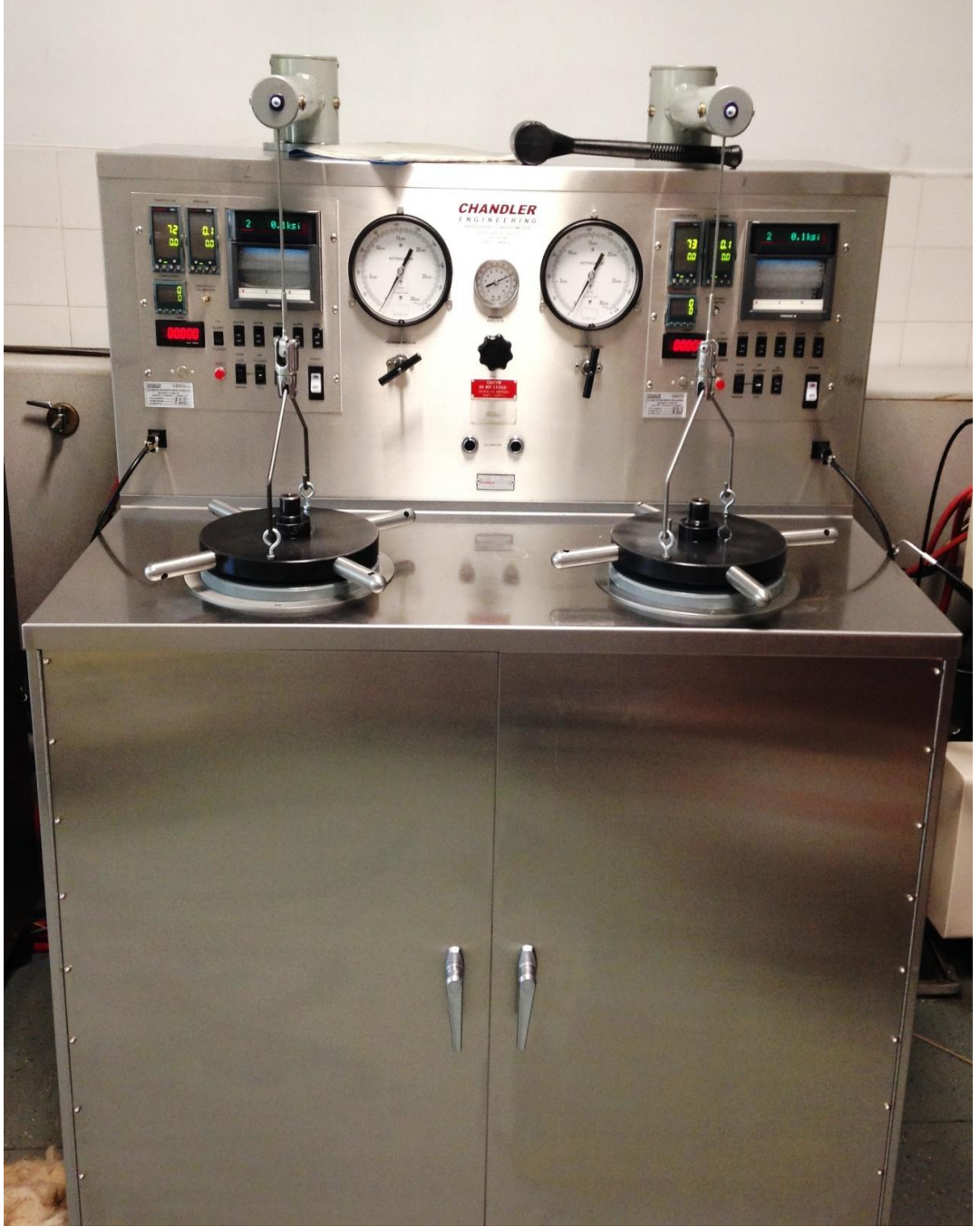
Şekil 3.9. Chandler Engineering 7025C10 model prizlenme süresi ölçüm cihazı
