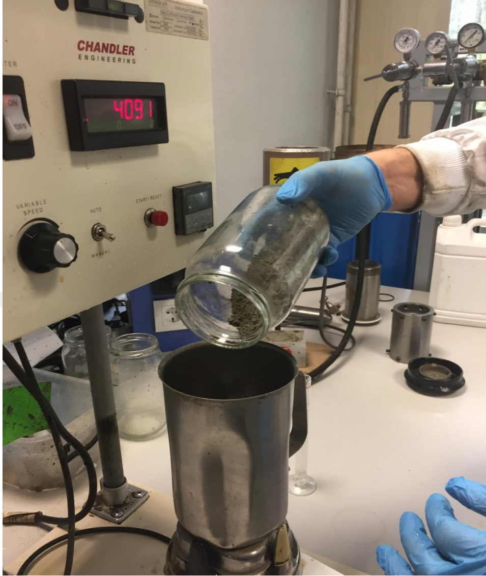
Şekil 3.7. Çimento karışımlarında kullanılan karıştırıcı ve çimento ilavesi
