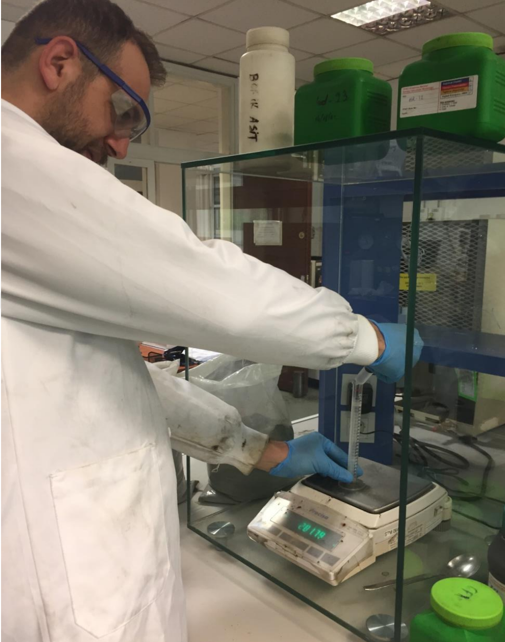
Şekil 3.5. Çimento karışımlarında kullanılan suların hassas miktar tespiti
