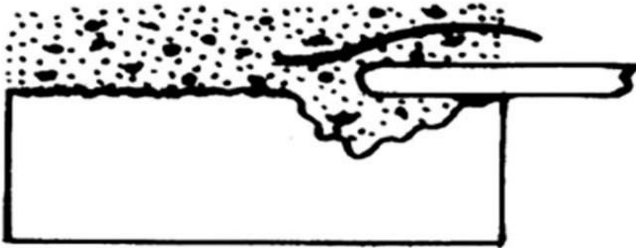
Şekil 2.5. Çatlak korozyonu (Al-Eidan 2015)
