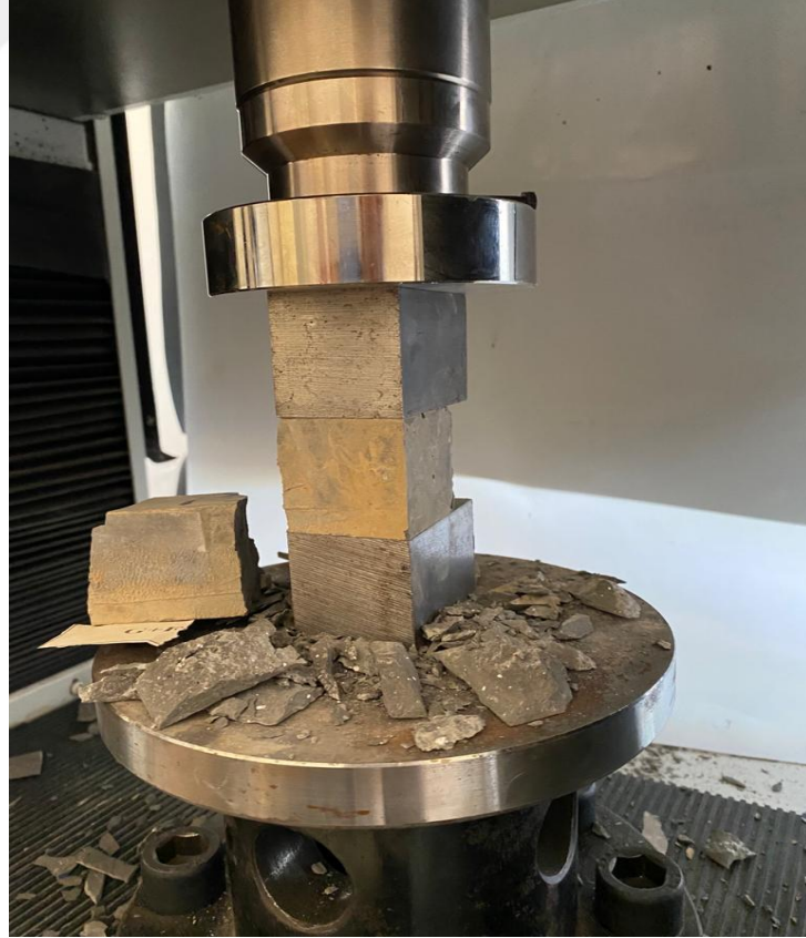
Şekil 4. 18. Tek eksenli basınç deneyi
