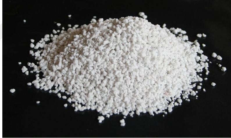
Şekil 4. 1. Yapılarını ve birleşimlerini bozmadan hacimlerinin, boylarının arttırılmasıyla elde edilen perlit
