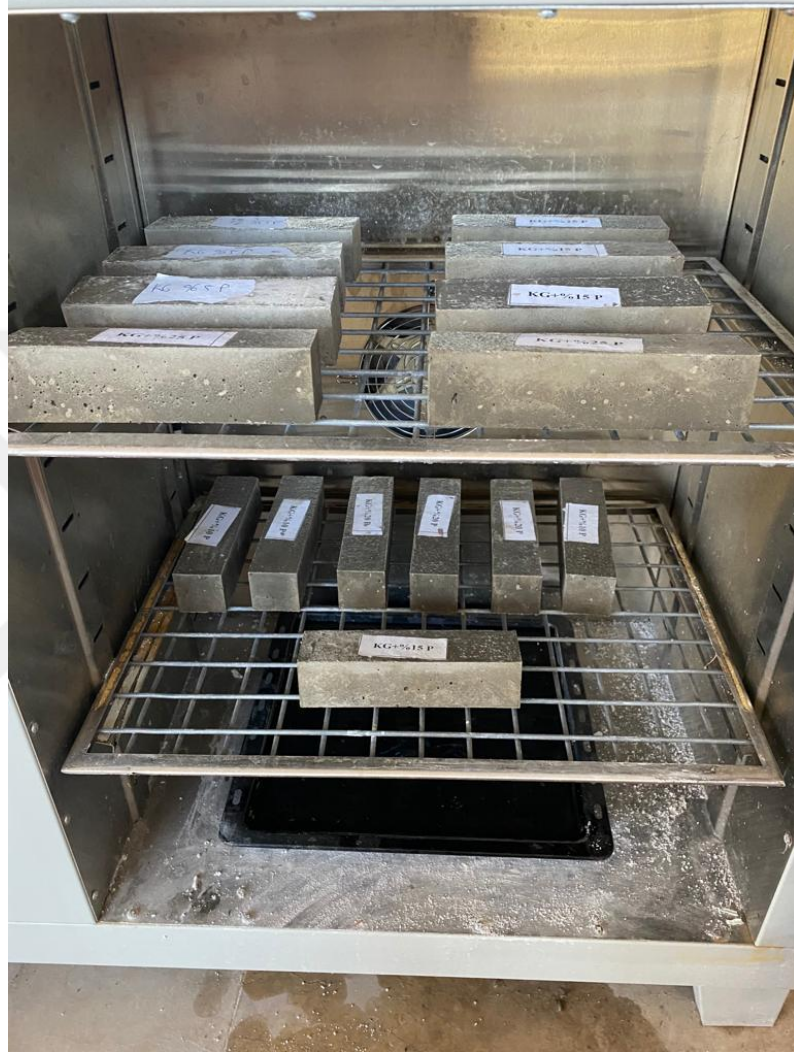
Şekil 4. 8. Hazırlanan örneklerin etüvde kurutulması ve kürlenmesi
