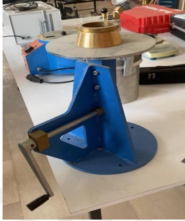
Şekil 4. 9. Mini çökme yayılma (slump) deney cihazı
