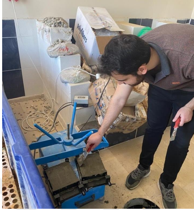
Şekil 4. 6. Numunenin kalıba doldurulması ve şekil verilmesi
