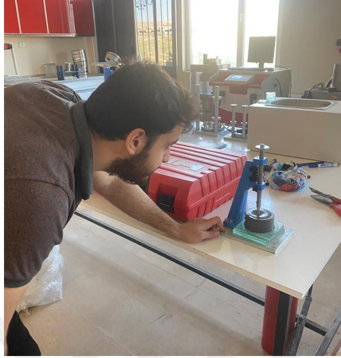
Şekil 4. 11. Vikat cihazından kıvam tayini ölçümü
