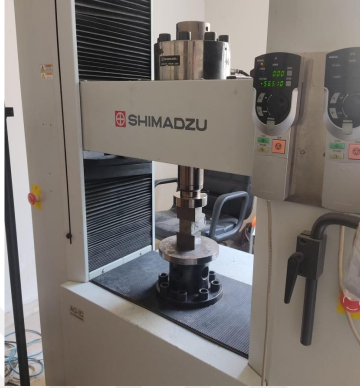
Şekil 4. 17. Numunenin basınç deneyi cihazına yerleştirilmesi
