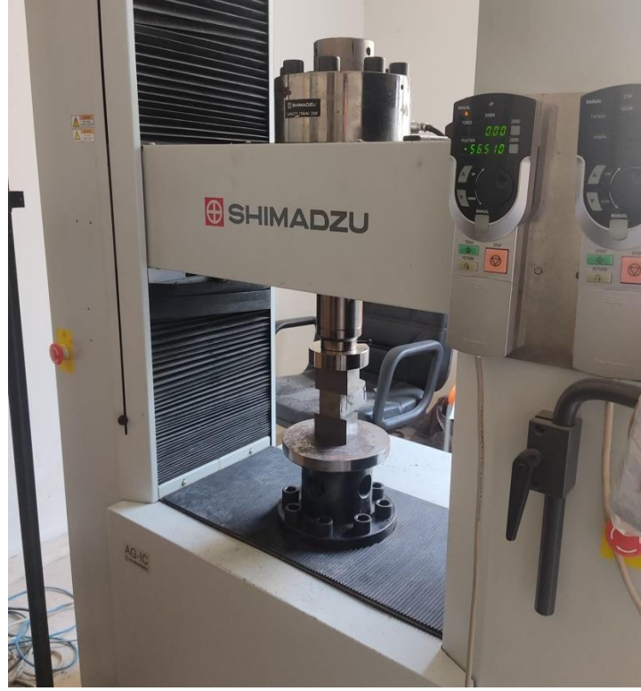
Şekil 4. 17. Numunenin basınç deneyi cihazına yerleştirilmesi
