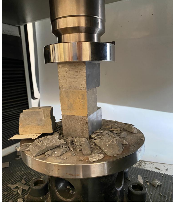
Şekil 4. 18. Tek eksenli basınç deneyi
