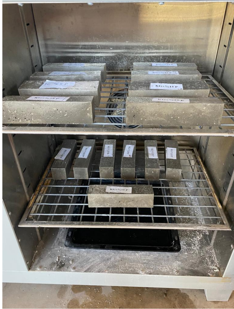
Şekil 4. 8. Hazırlanan örneklerin etüvde kurutulması ve kürlenmesi
