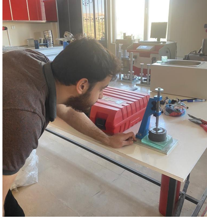
Şekil 4. 11. Vikat cihazından kıvam tayini ölçümü
