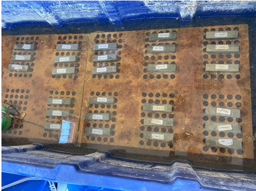
Şekil 4. 7. Numunelerin kür havuzuna yerleştirilmesi
