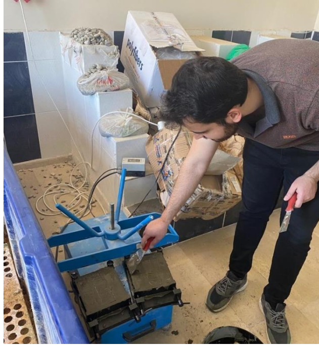
Şekil 4. 6. Numunenin kalıba doldurulması ve şekil verilmesi
