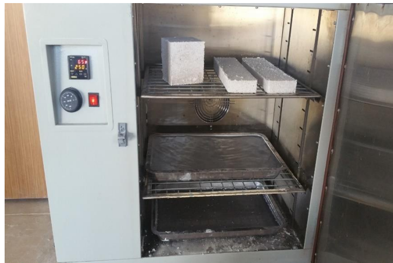
Şekil 5.11. Etüvde kurutulma ve kürlenme
