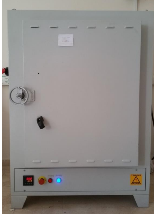
Şekil 5. 15. Rötire testi için kullanılan fırın
