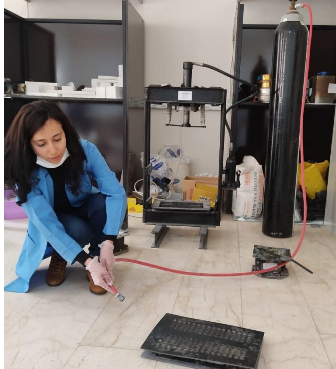
Şekil 5. 9. Karbondioksit Gazı ile sertleştirme
