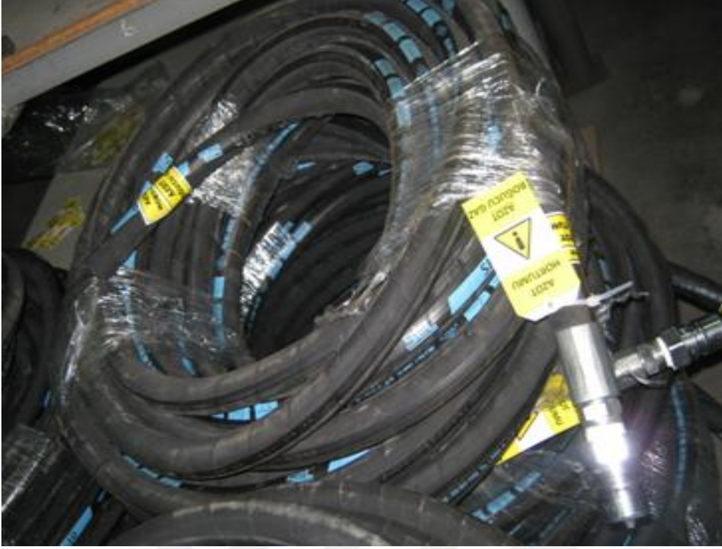
Resim 10. Azot Çıkış Hattına Bağlanan Erkek Quick Kaplin
