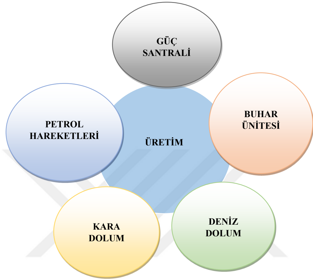
Şekil 12. Bir Petrol Rafinerisindeki Yardımcı Tesisler
