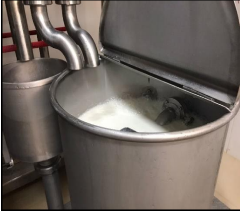
Şekil 3.4. Süt pastörize pişirme ünitesi ve borulu pastörizatör
