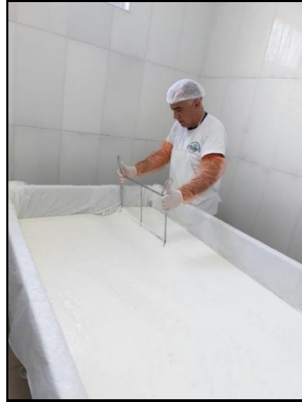
Şekil 3.7. Peynir kırımı ve kesimi
