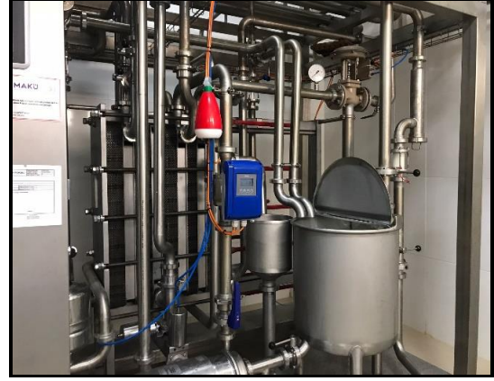
Şekil 3.4. Süt pastörize pişirme ünitesi ve borulu pastörizatör
