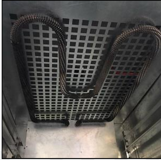
Şekil 3.10. Kabin tipi tepsili peynir kurutma makinesi serpantinli rezistansı
