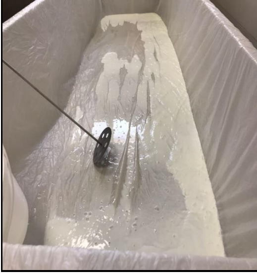
Şekil 3.6. Sütün peynir teknesine gelişi, peynir enzimi ve kalsiyum ilavesi ile dalgalandırılması
