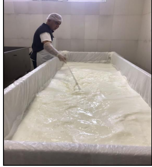
Şekil 3.6. Sütün peynir teknesine gelişi, peynir enzimi ve kalsiyum ilavesi ile dalgalandırılması
