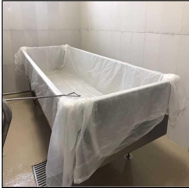
Şekil 3.1. Peynir teknesi ile altta cendere bezi üstte tek kullanımlık branda
