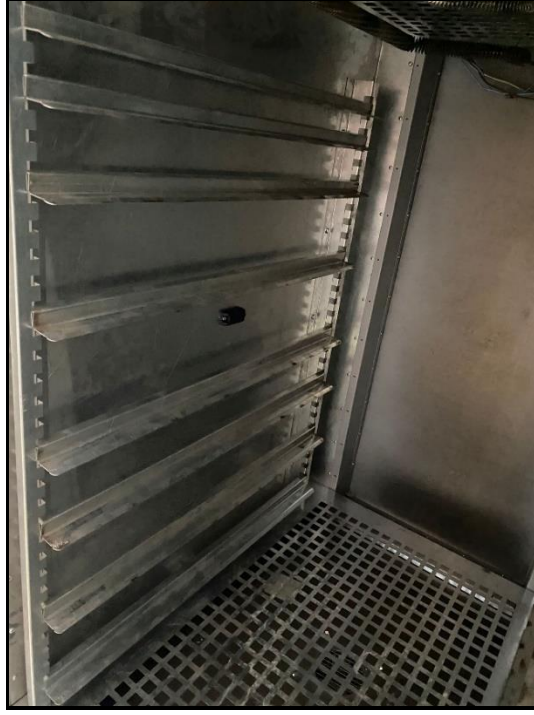
Şekil 3.17. Peynir kurutma makinesi kabin içi sıcaklık ve nem sensörü
