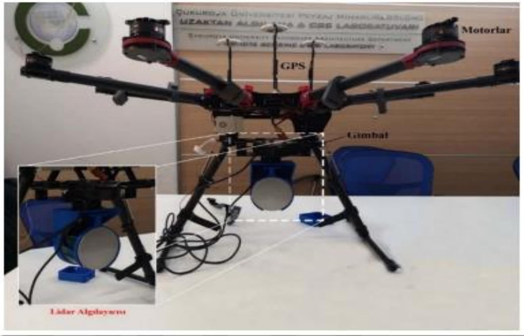
Şekil 4.14 İnsansız hava araçlarında lidar algılayıcılar
