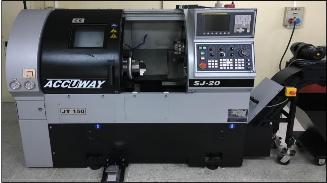
Şekil 8.1. Accuway JT 150 CNC torna tezgâhı.
