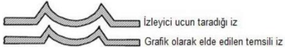
Şekil 4.10. İzleyici uçtan kaynaklanan ölçüm hatası [88].
