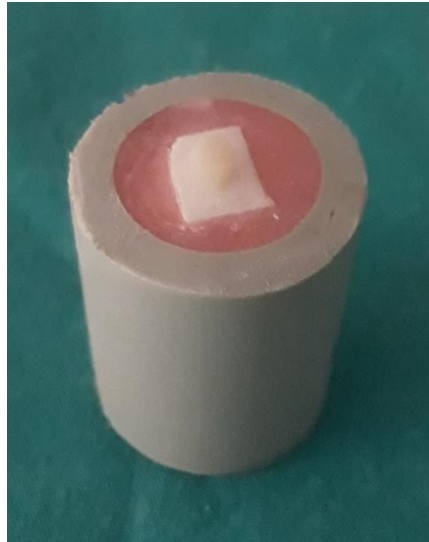
Resim 6: Kompozit ile restore edilmiş örnek.
