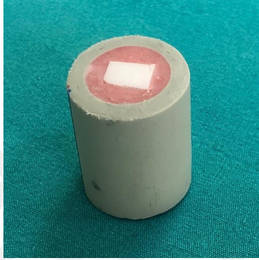
Resim 1: Yüzey işlemleri için hazırlanan Y-TZP blok örneği.
