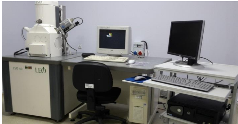
Şekil 3.2. LEO Evo 40 SEM cihazı
