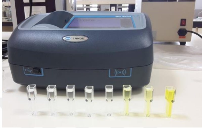
Şekil 3.3. DR 3900 HACH marka UV-Vis spektrofotometre cihazı
