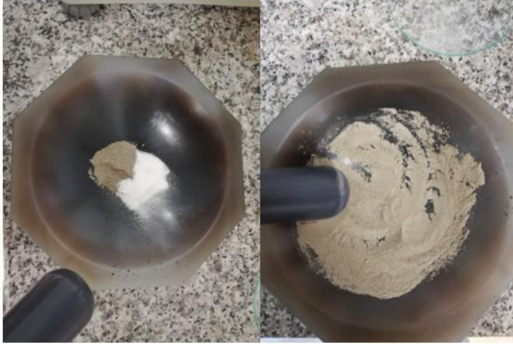
Şekil 3.6. Homojen karıştırma işlemi
