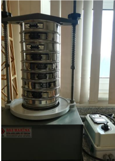
Şekil 3.3. Elek seti ve titreşim cihazı
