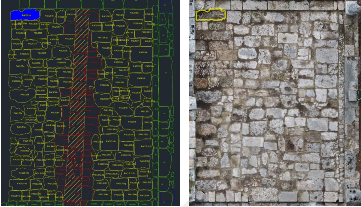
Şekil 3.4. Ortofoto görünümünün AutoCad üzerinden çizimlerinin yapılması ve ilgili blokların görünümlerinin alınması (Gökaydın, 2025).
