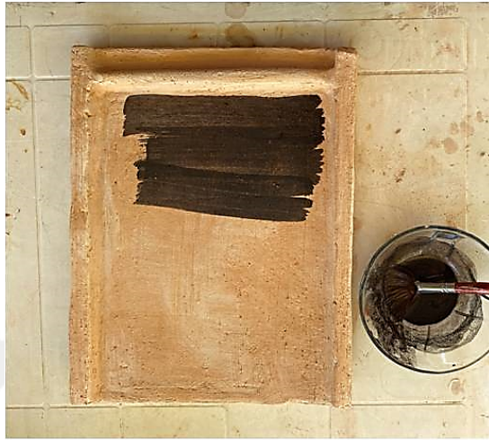
Şekil 35- Oksit ile renklendirme (Fotoğraf: M. Aslı Gördes)
