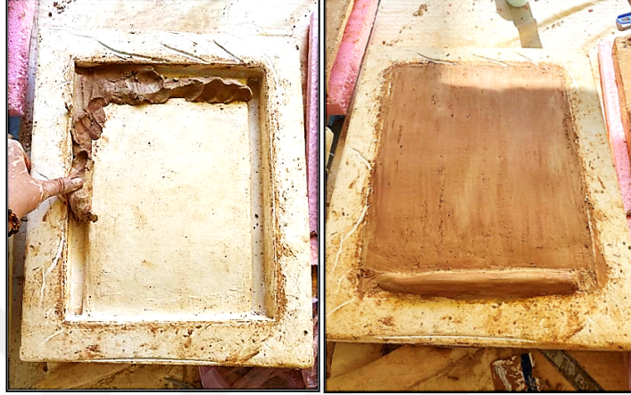
Şekil 30- Stroter kapama kiremidi kalıbına çamurun basılması (Fotoğraf: M. Aslı Gördes)
