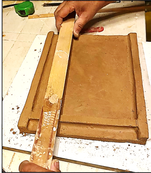
Şekil 18- Stroter modeli hazırlanması (Fotoğraf: M. Aslı Gördes)
