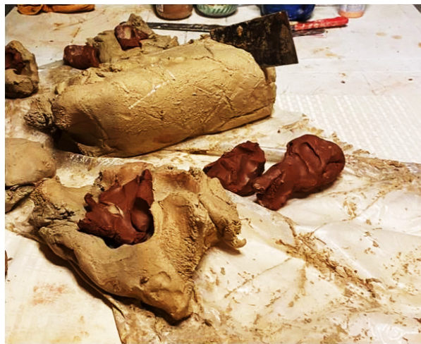
Şekil 15- Kiremitler için farklı iki tip çamurun karıştırılmak üzere hazırlanması (Fotoğraf: M. Aslı Gördes)
