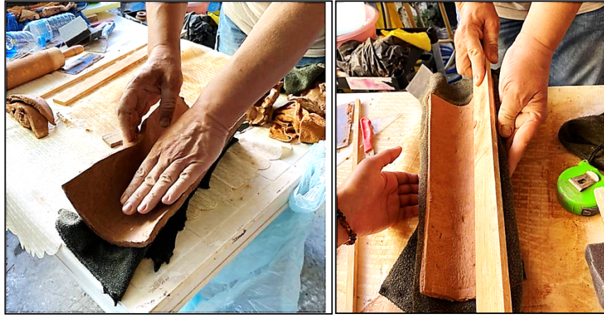
Şekil 26- Plakaların kalıp olarak kullanılan kapama kiremitlerine yerleştirilmesi (Fotoğraf: M. Aslı Gördes)
