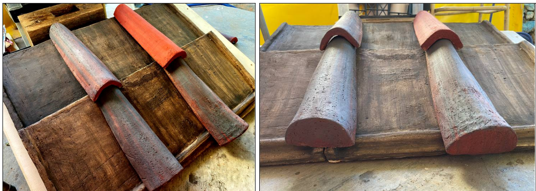
Şekil 36- Fırından çıkan çatı elemanlarının tekrar dizilimi
