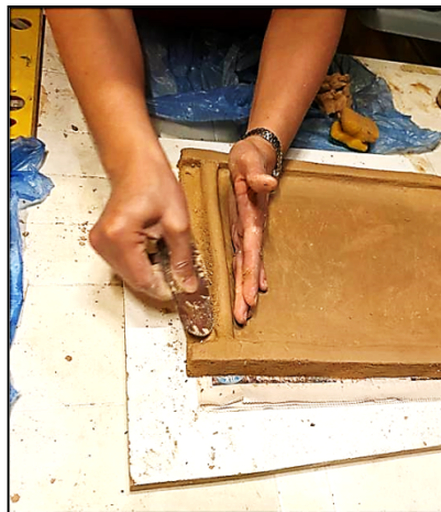
Şekil 17- Stroter kalıbı için stroter modeli hazırlanması (Fotoğraf: M. Aslı Gördes)
