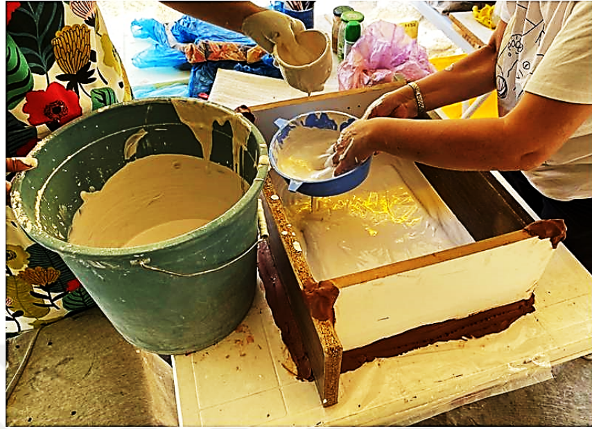
Şekil 22- Alçının bir elekten geçirilerek kalıba yavaşça dökülmesi (Fotoğraf: Metin Gördes)
