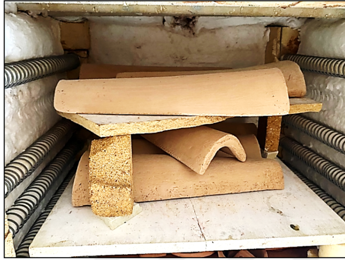
Şekil 33- Kalypterlerin fırına yerleştirilmesi (Fotoğraf: M. Aslı Gördes)
