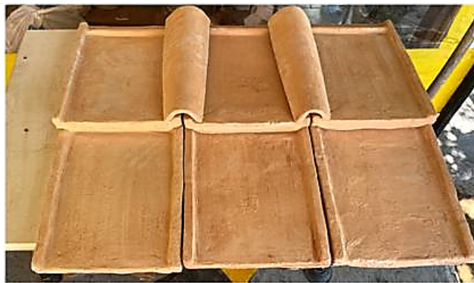
Şekil 34- İlk pişirimi yapılan çatı elemanlarının örnek dizilimi (Fotoğraf: M. Aslı Gördes)
