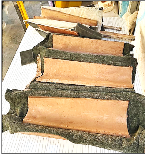
Şekil 27- Kalypterlerin kalıplara konulduktan sonra kurumaya bırakılması (Fotoğraf: M. Aslı Gördes)
