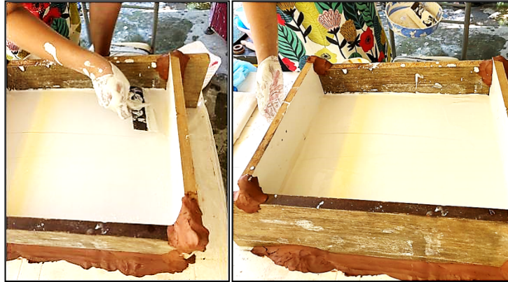
Şekil 23- Kalıba dökülen alçının donmadan hemen önce yüzeyinin düzeltilmesi (Fotoğraf: Serpil Gördes)
