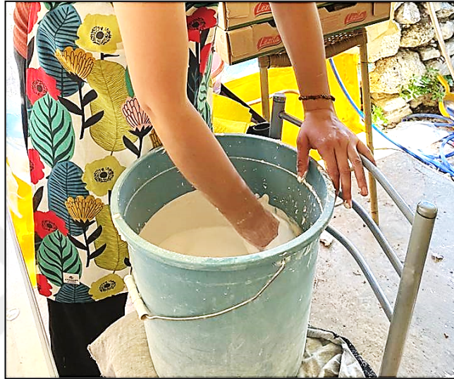
Şekil 21- Kalıba dökmek üzere alçı karışımının hazırlanması (Fotoğraf: Serpil Gördes)
