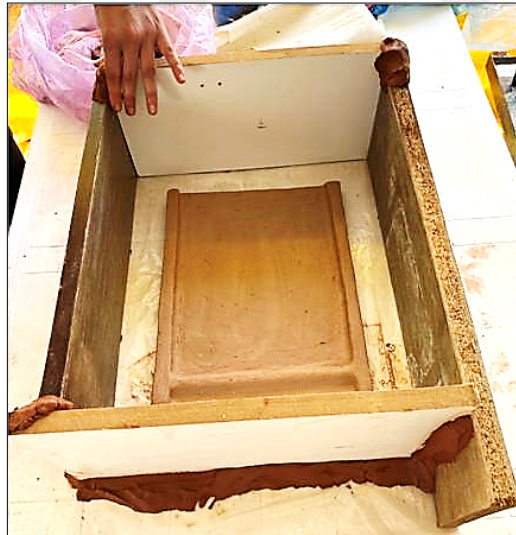
Şekil 20- Kalıp kenarlarının çamur ile sabitlenmesi ve gönyenin oturtulması (Fotoğraf: Serpil Gördes)
