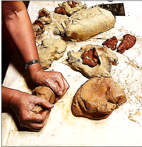
Şekil 16- Hazırlanan çamurun yoğurulması (Fotoğraf: Serpil Gördes)
