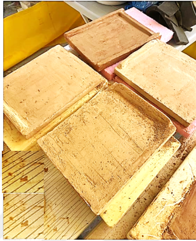
Şekil 32- Kalıptan çıkarılan stroterlerin kurumaya bırakılması (Fotoğraf: M. Aslı Gördes)
