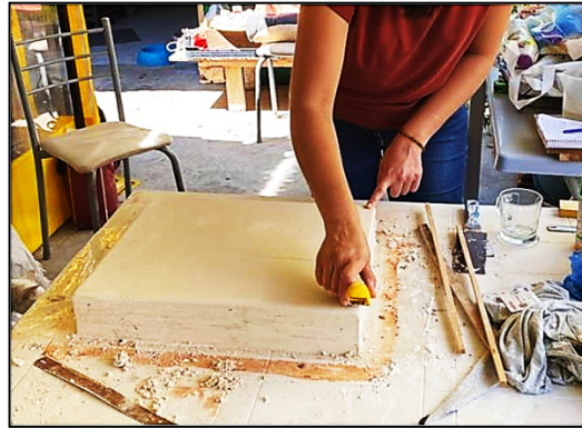
Şekil 24- Kurgusu açılan kalıbın düzeltme işlemlerinin yapılması (Fotoğraf: Serpil Gördes)
