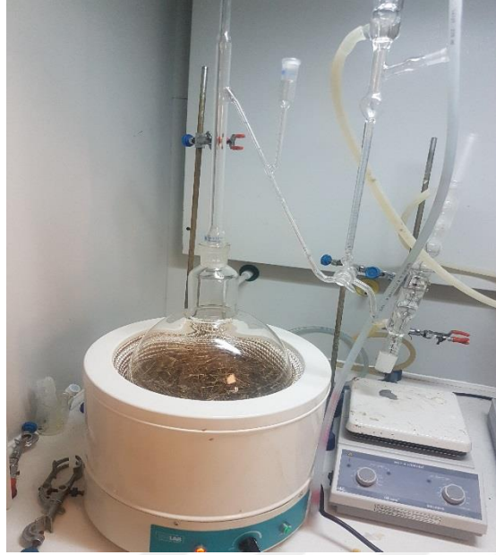
Şekil 3.4. Hidrodistillasyon yöntemi ile uçucu yağ ekstraksiyonu.
