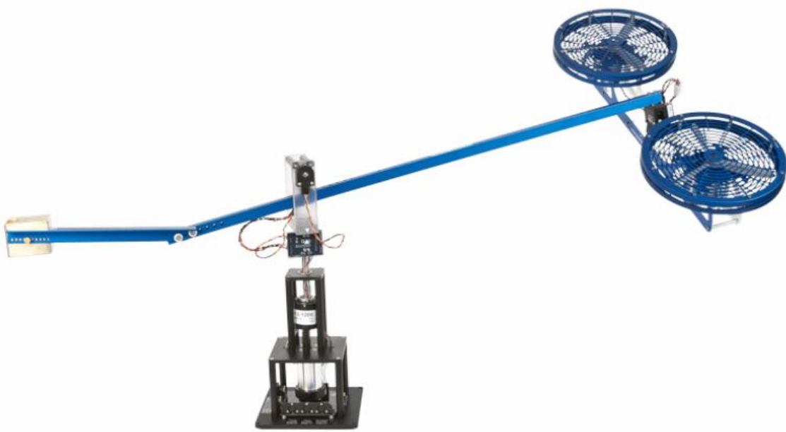
Şekil 1.2. Quanser firması tarafından üretilen 3 serbestlik dereceli helikopter mekanik ünitesi
