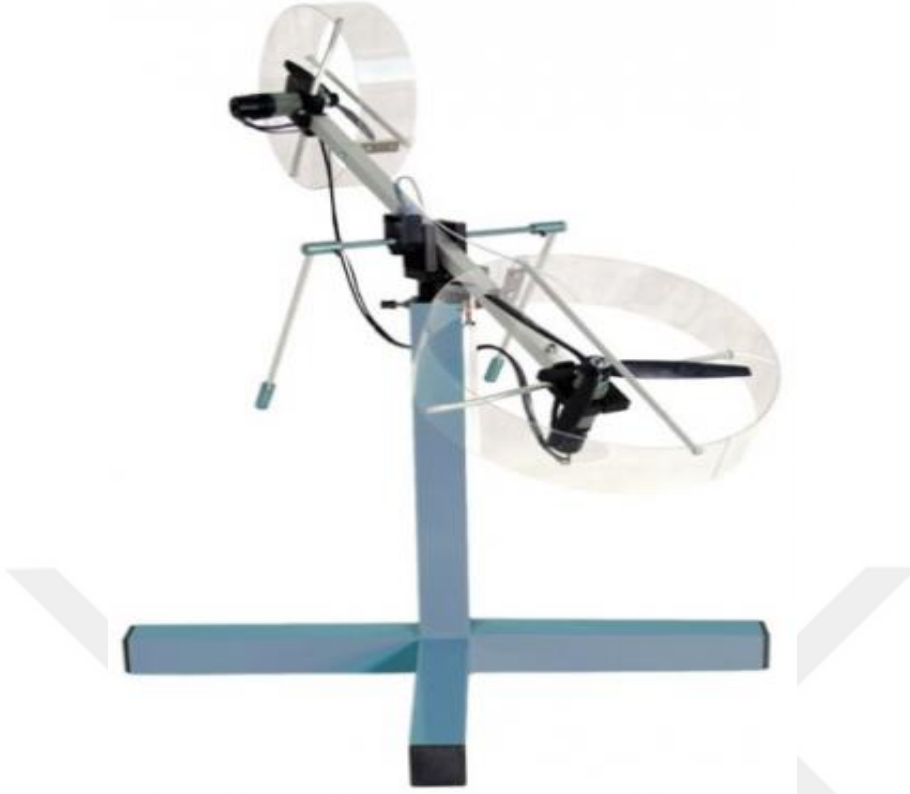
Şekil 1.1. Bytronic firması tarafından üretilen TRMS mekanik ünitesi
