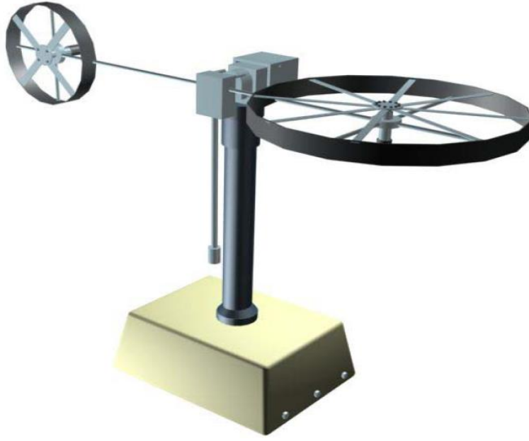
Şekil 1.5. Feedback Inc. firması tarafından üretilen TRMS mekanik ünitesi
