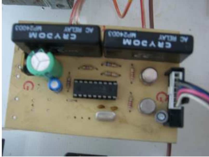
Şekil E1.d. PIC Kontrol Devresi
