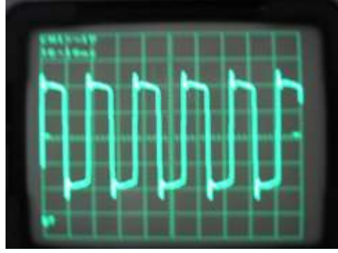
Şekil 8.3.(b) Kesintisiz Güç Kaynağı (Yüklü durumda) çıkış gerilimi
