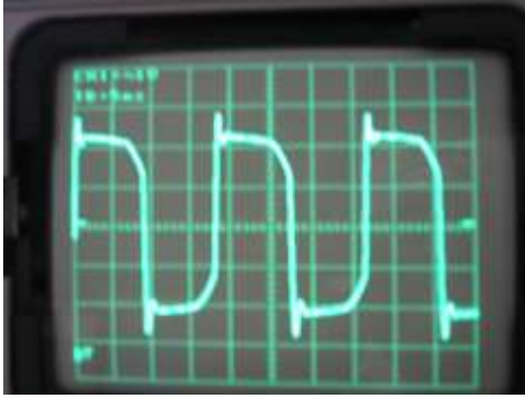
Şekil 8.3.(c) Kesintisiz Güç Kaynağı (Yüksüz durumda) çıkış gerilimi
