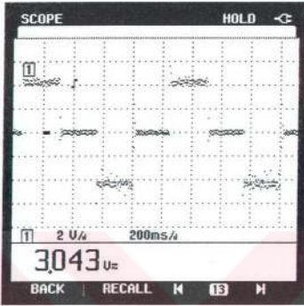
(a) Bipolar adım motorunun birinci faz sargısının üzerinde oluşan gerilim dizisi.
