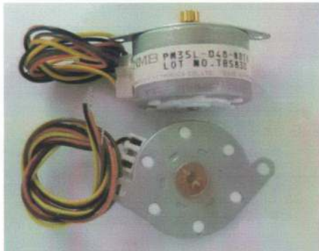
Şekil 4.7: Uygulama devresinde kullanılan unipolar adım motorlarının resmi.
