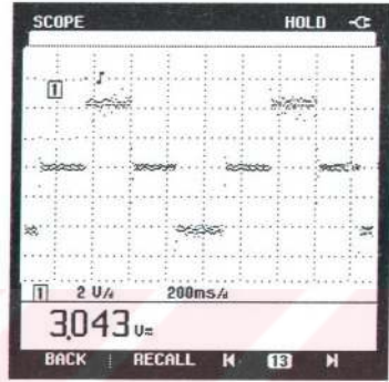
(b) Bipolar adım motorunun ikinci faz sargısının üzerinde oluşan gerilim dizisi.
