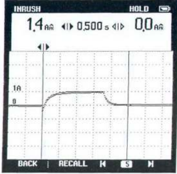
(b) Bipolar adım motorunun bir faz akımının dalga şekli.
