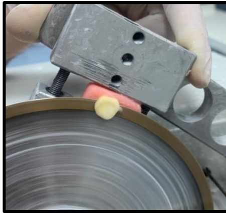
Resim 12. Dentin örneğinin elde edilmesi
