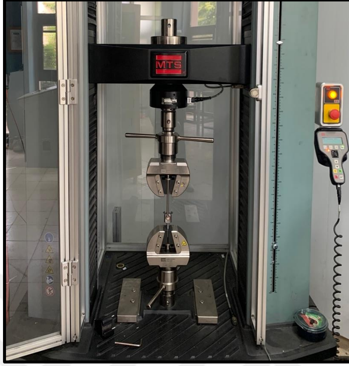
Resim 22: Universal test sistemi
