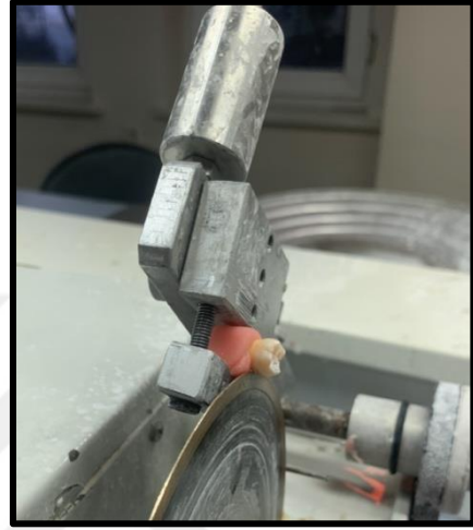
Resim 11. Dişlerin elmas separe ile bukkolingual yönde kesilmesi
