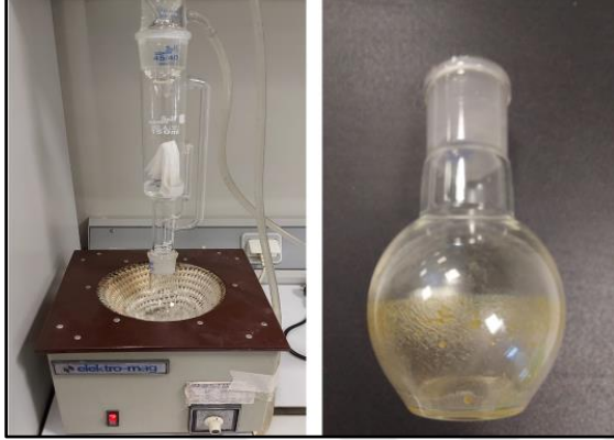
Resim 3.2. Lipit içeriğinin reflüks cihazı ile belirlenmesi
