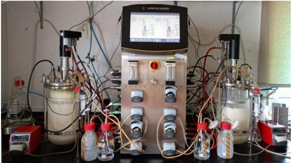
Şekil 3. 5. Laboratuvar ölçekli fermantasyonların gerçekleştirildiği Sartorius Stedim BIOSTAT B fermentörü
