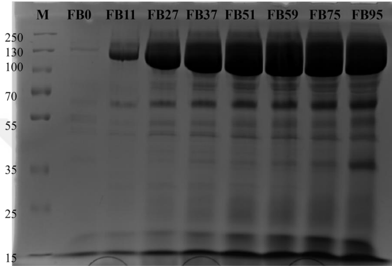
Şekil 4. 17. 5L’lik biyoreaktörde gerçekleştirilen üretimlerde zamana bağlı alınan örneklere ait SDS-PAGE analizi
