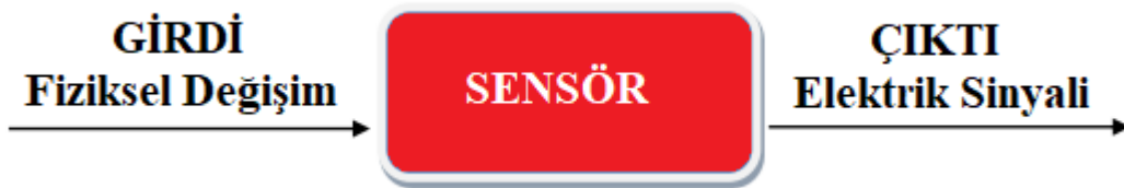
Şekil 2-16: Sensörlerin çalışma prensibi
