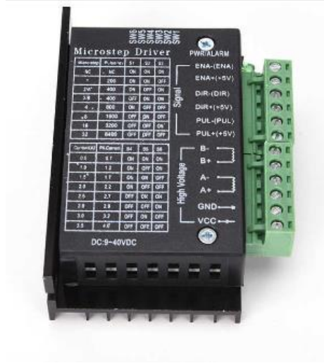
Şekil 3-7: TB6600 step motor sürücüsü
