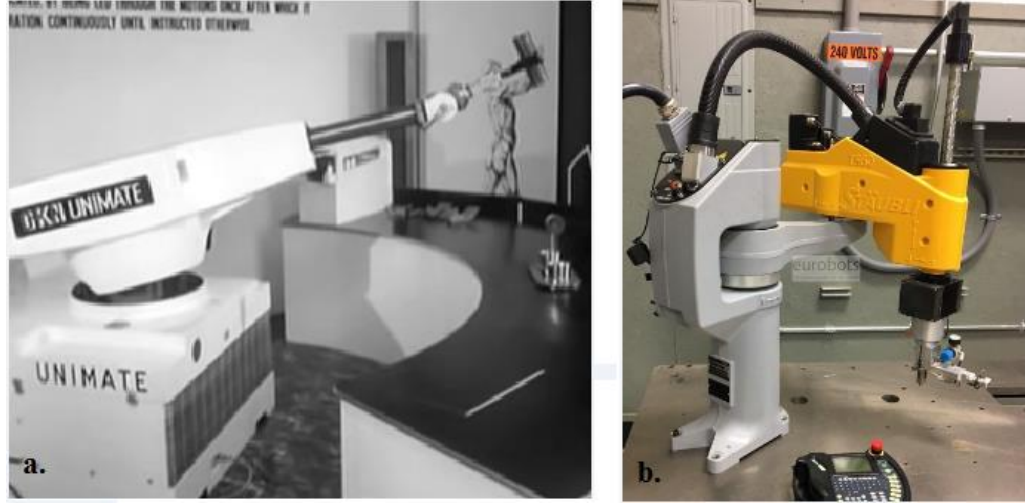
Şekil 2-2: Robot gelişimi için önemli endüstriyel robotlar; (a) Ultimate, (b) SCARA robot
