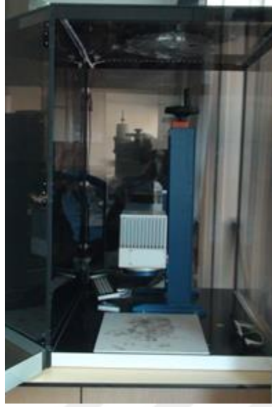
Şekil 6.24. İletken levhaların kesilmesinde kullanılan lazer kesim cihazı
