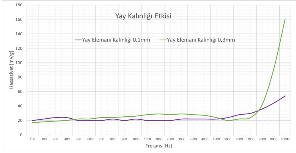
Şekil 6.70. Yay elemanın sismik kütle altında ve üstünde konumlandırıldığı durumda yay elemanı et kalınlığının hassasiyete etkisi
