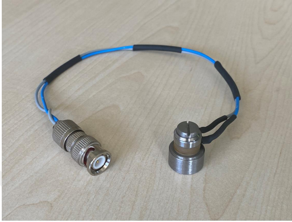
Şekil 6.29. Kablo bağlantısı yapılmış BNC konnektörlü prototip ivmeölçer
