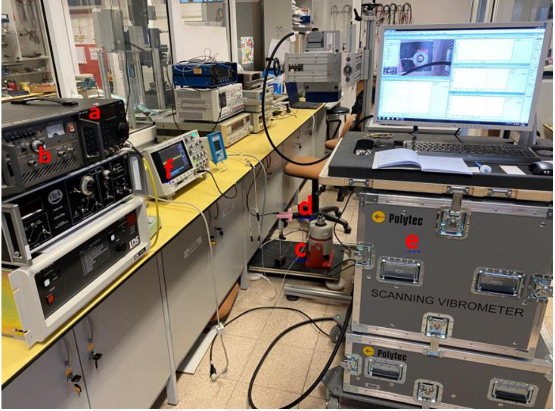
Şekil 6.30. Deney düzeneği a) Sinyal jeneratörü, b) Sinyal güçlendirici, c) Titreştirci d) İvme sensörleri, e) Titreşim tarayıcı, f) Osiloskop
