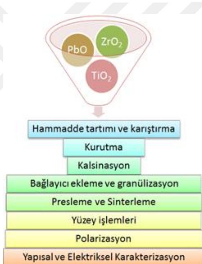
Şekil 6.3. Piezoelektrik seramik malzemelerin sentezleme üretim şeması
