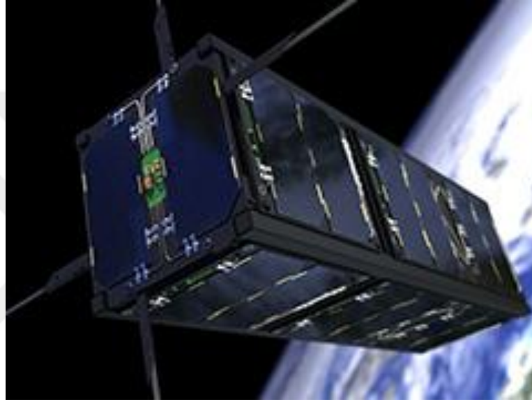
Şekil 5.9. Avrupa birliği FP7 projesi PEASSS, Piezo malzemeler ile giydirilmiş akıllı uydu yapısı
