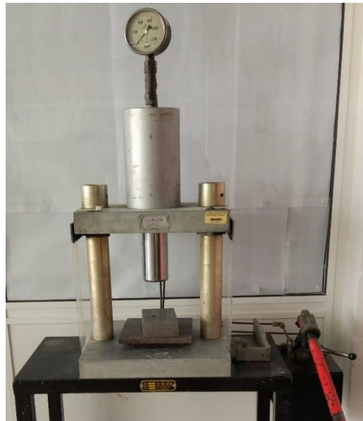
Şekil 6.7. Seramik malzeme üretiminde kullanılan pres
