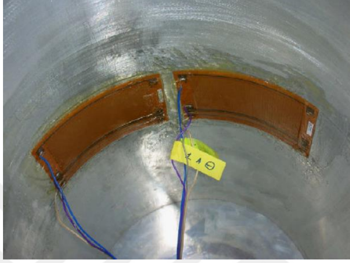
Şekil 5.10. Alüminyum silindirik yapı üzerinde MFC piezoelektrik eyleyiciler
