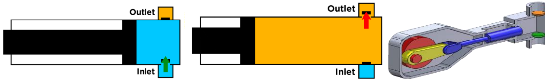
Şekil 5. Pistonlu pompaların (resiprokal pompa) çalışma prensibi
