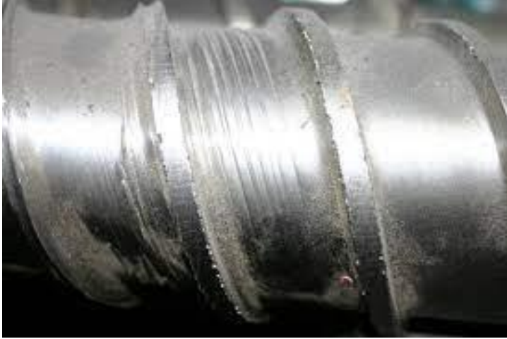
Şekil 5.5. Abrasiv aşınma örneği [89]
