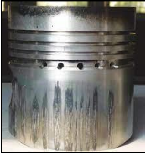
Şekil 5.3. Adhesiv piston aşınması örneği [88]
