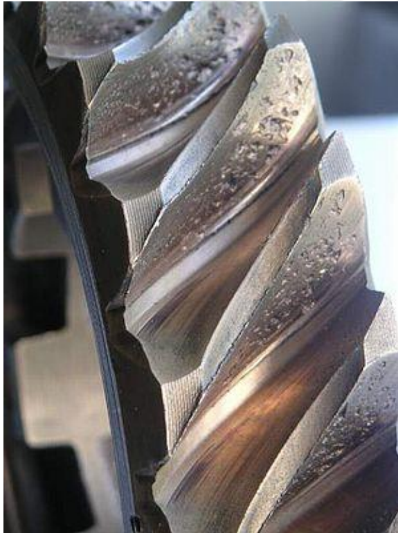
Şekil 5.6. Yorulma aşınması örneği [92]
