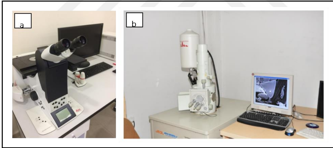
Resim 7.7. a) Leica DMI 5000M optik mikroskop b) Jeol SEM 6060 LV mikroskobu
