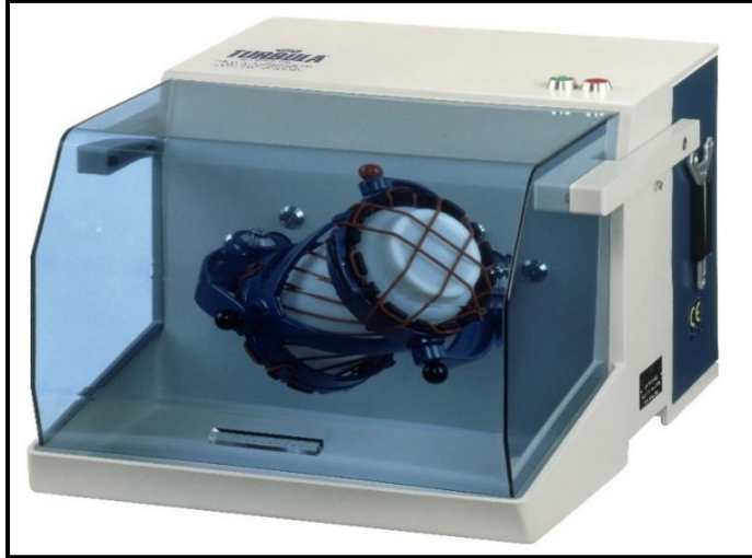
Resim 7.2. Tozların karıştırıldığı turbula cihazı
