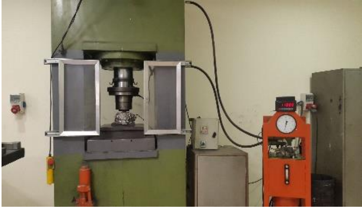
Resim 7.3. Sıcak presleme yapılan hidrolik pres
