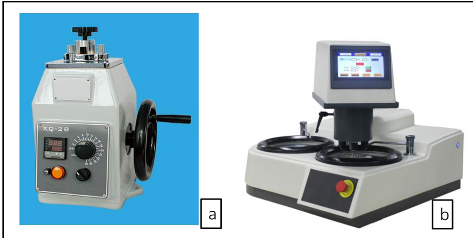
Resim 7.5. a) Sıcak bakalite alma cihazı b) Otomatik parlatma cihazı
