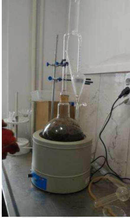
Fotoğraf 3.4. Clevenger uçucu yağ cihazı
