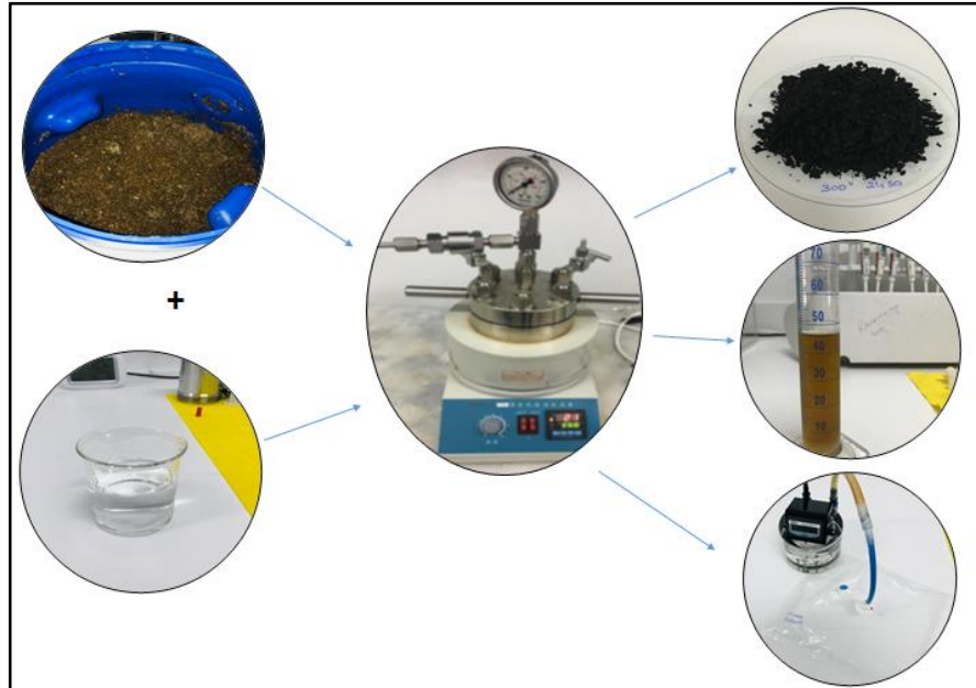
Şekil 9.1. Hidrotermal karbonizasyon işlemi giriş ve çıkış ürünleri
