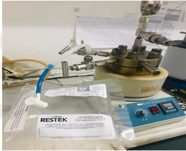
Şekil 8.6. HTK işlemi sonrası gaz ürünün toplanması
