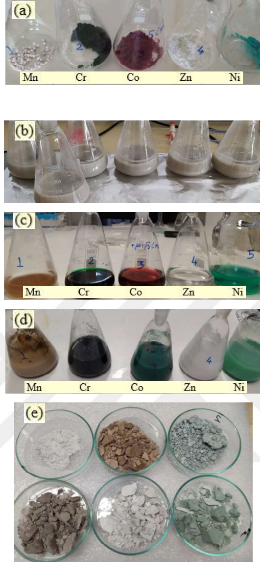
Şekil 3.1. (a) Mangan, Krom, Kobalt, Çinko ve Nikel metalleri (b) Saf su/Montmorillonit (c) Metal/NaOH çözeltileri (d) Kil/(Metal/NaOH) çözeltileri (e) Metal katalizörler
