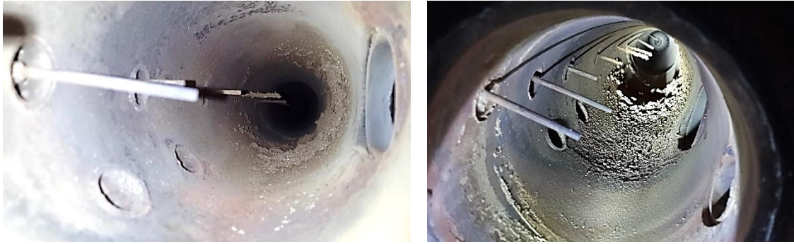
Şekil 4.41. Yıkılmış pirina (yatak malzemesi: kum) yakma deneyi sonunda yakıcı iç yüzeyinin görüntüsü (Deney 8; T_{yatak} = 850\text{ }^{\circ}\text{C} )
