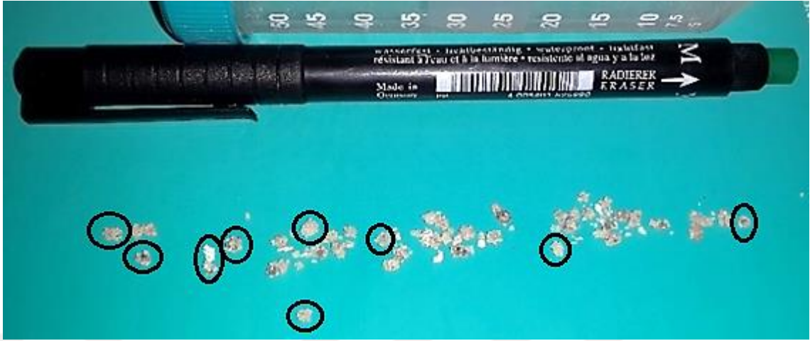
Şekil 4.21. Pirina (yatak malzemesi: kum) yakma deneyinde elde edilen topaklaşmış dip külü ve yatak malzemesinin görüntüsü (Deney 7; T_{\text{yatak}} = 850^{\circ}\text{C} )
