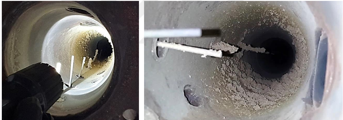
Şekil 4.24. Pirina (yatak malzemesi: kum) yakma deneyi sonunda yakıcı iç yüzeyinin görüntüsü (Deney 7; T_{\text{yatak}} = 850^{\circ}\text{C} )
