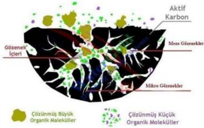
Şekil 2.5 Kirleticilerin aktif karbon yüzeyine tutunması (Kızıl, 2022).
