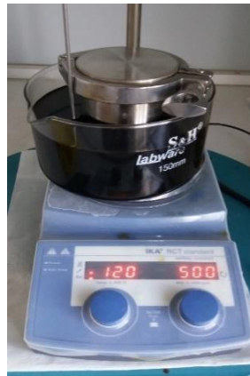
Resim 3.5 PHMF reçine sentezinde kullanılan çelik reaktör.
