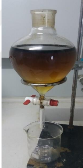
Resim 3.7 PHMF reçine fazı ile sulu fazı ayırma işlemi.
