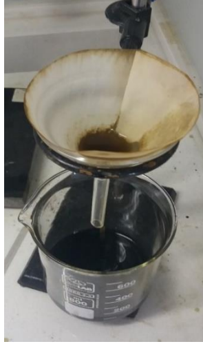
Resim 3.6 Reçine karışımından aseton ile çözünmeyen kalıntıların süzülerek uzaklaştırılması.
