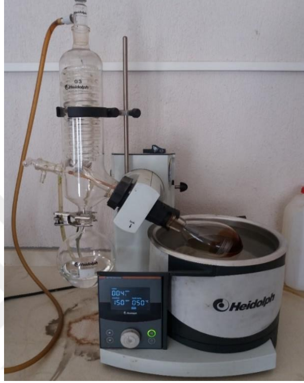
Resim 3.2 Rotary evaporatörü ile biyoyağdan çözücünün uzaklaştırılması.
